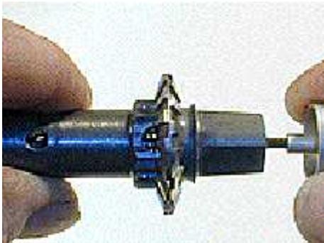
Das Herzstück des **mountain-drive** - Getriebes ist die auf der Achse verschiebbare Kupplung. Sie wird durch Drücken des Schaltknopfes auf der linken oder rechten Seite der Achse mit dem entsprechenden Teil des Planetengetriebes gekoppelt.
