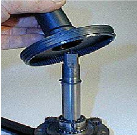
Das Getriebe ist so ausgelegt, dass es ohne Spezialwerkzeuge einfach zerlegt werden kann, wenn es je gründlich gereinigt werden sollte.
