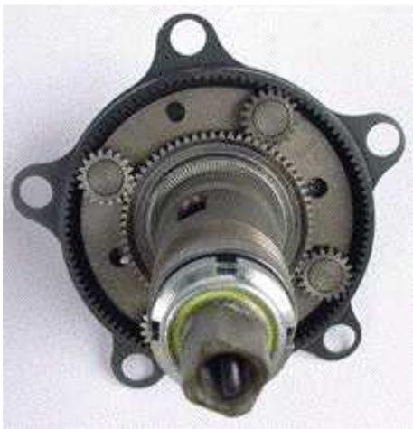
Ein Blick ins Innenleben zeigt die Einzelteile des Planetengetriebes: rund um ein zentral angeordnetes Sonnenrad kreisen sog. Planetenräder, die sich wiederum an einem innenverzahnten Hohlrad abwälzen.
